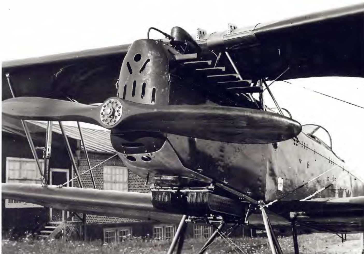
Sk 6 Heinkel HD 36 användes vid F 5 för avancerad skolning från 1929 till 1939. Prov med modifierad kylanordning i september 1931. Foto i Krigsarkivet.
